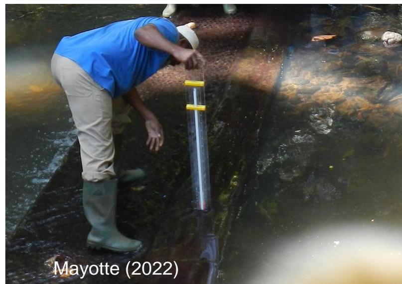
Possible de jauger sur seuil épais, là où la profondeur serait trop faible pour un moulinet ou un courantomètre
