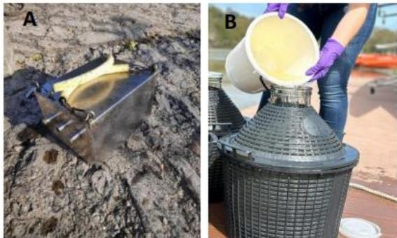
Figure 1. Méthodes d'échantillonnage des MES ; A : échantillonnage intégratif par piège à particules ; B : échantillonnage ponctuel par décantation de gros volumes d'eau (référence)
