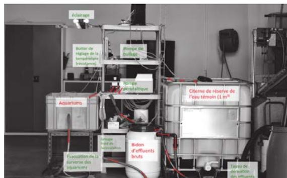
*Dispositif expérimental d'exposition des organismes à des effluents*
